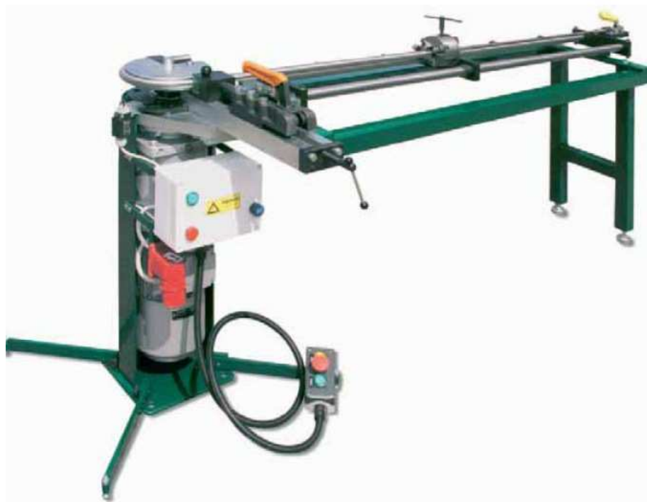
Proces gięcia rurki o wymiarach: φ 32 x 1,5 mm
