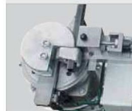
Mocowanie materiału do gięcia. Wymiar materiału: 30 x 20 x 2 mm
