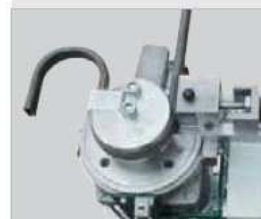
Proces gięcia płaskownika o wymiarach: 30 x 15 mm
