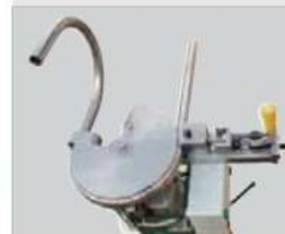
Proces gięcia rurki o wymiarach: φ 32 x 1,5 mm
