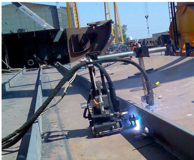
Dwustronne spawanie usztywnień
